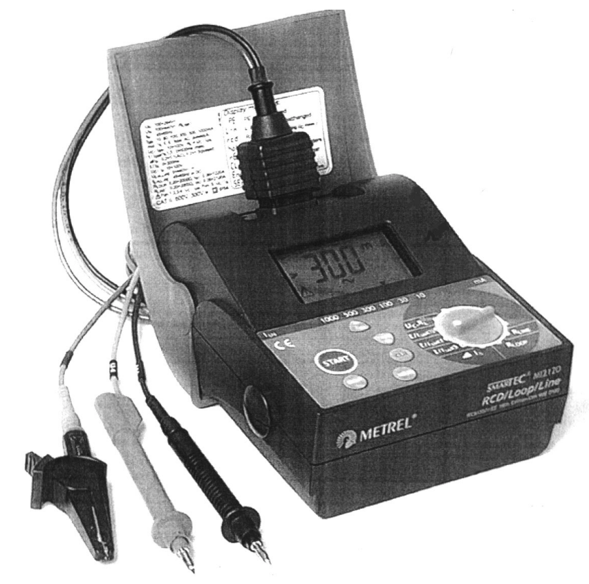
Slika 1. Mjerilo otpora zamke tip SMARTEC RCD Loop/Line MI 2120
